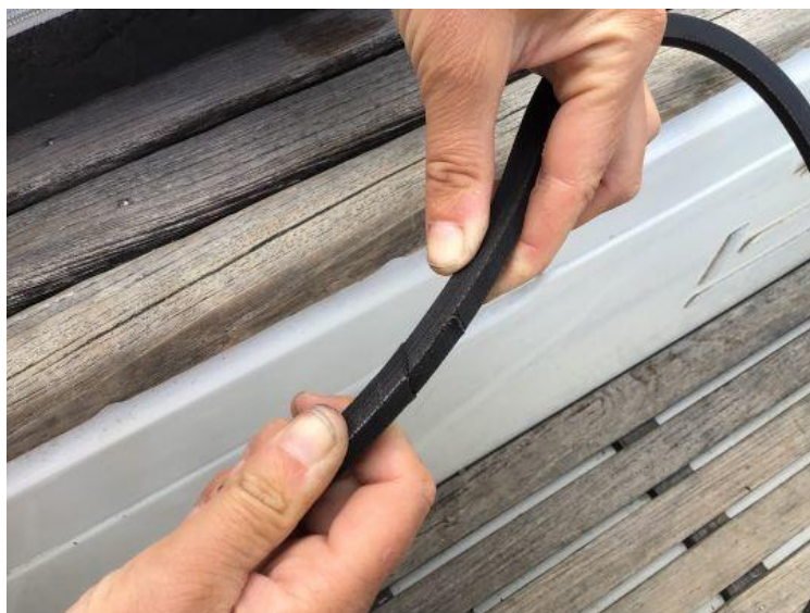
Courroie moteur en mauvais état
