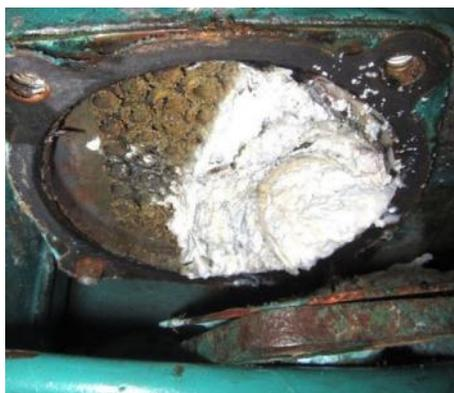
*Un échangeur moteur totalement obturé*
